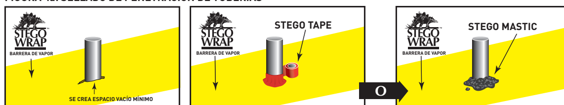
FIGURA 4a: SELLADO DE PENETRACIÓN DE TUBERÍAS
